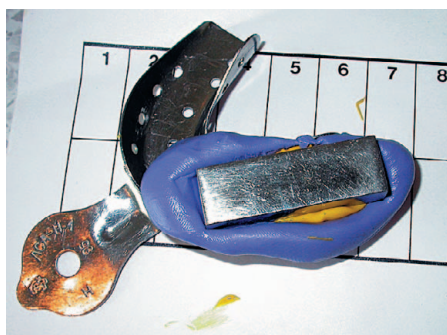
Рис.27. Получение оттиска с экспериментальной модели (1 способ) для определения размерной точности
