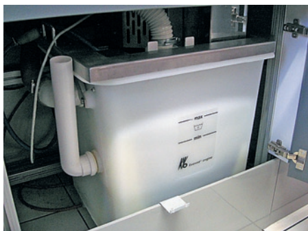
Рис.58. Емкость с охлаждающей жидкостью (Everest)
