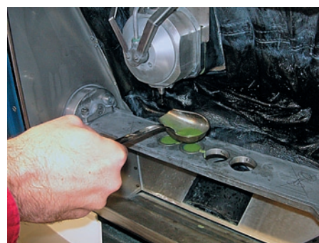
Рис.49. Заливка воском отфрезерованной внутренней поверхности заготовки
