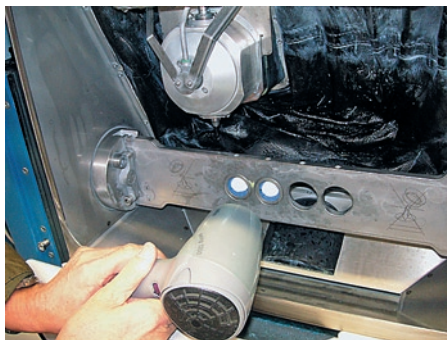
Рис.47. Высушивание заготовок бытовым феном
