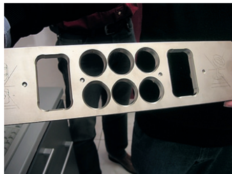
Рис.46. Зажимные мосты отличаются посадочными местами для заготовок
