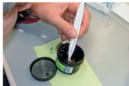
Рис.63. Окрашивание в специальном растворе методом погружения (Everest)
