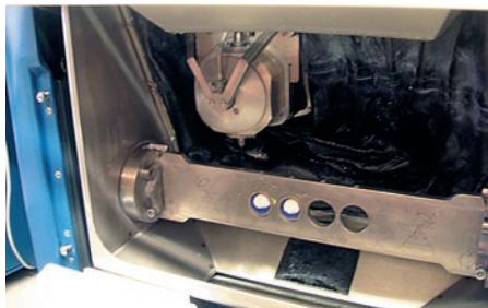
Рис.44. Зажимной мост повернут для обслуживания заготовок
