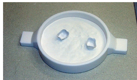
Рис.61. Специальная тарелка с песком для размещения отфрезерованных конструкций перед обжигом (Everest)
