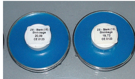
Рис.45. Заготовки с указанным коэффициентом усадки зафиксированы воском
