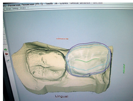
Рис.34. Управляющие линии на зубе из банка данных для его адаптации к границам препарирования (Cerec inLab)
