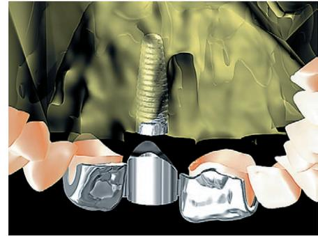
Рис. 15. После согласования положения имплантата с хирургом приступали к виртуальному моделированию хирургического шаблона
