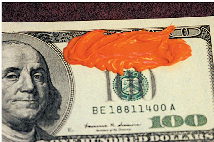
Рис.1,2. Получение отпечатка микрорельефа банкноты с помощью корректирующего оттискного материала *Honigum light* (DMG)
