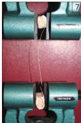
■Рис. 5. Одна заготовка закреплена в зажимном устройстве, вторая висит в качестве отвеса
