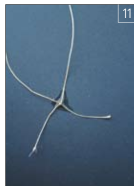
■Рис. 12. Узел, полностью затянутый в капле адгезива
