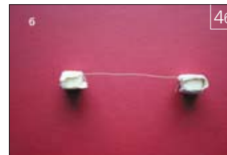
■Рис. 5. Одна заготовка закреплена в зажимном устройстве, вторая висит в качестве отвеса
