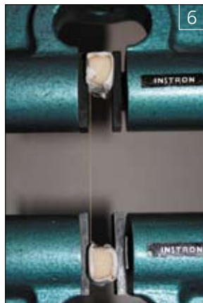
■Рис. 4 а, б. Заготовки, обмотанные тремя слоями лейкопластыря: а-вид сверху; б-вид сбоку
